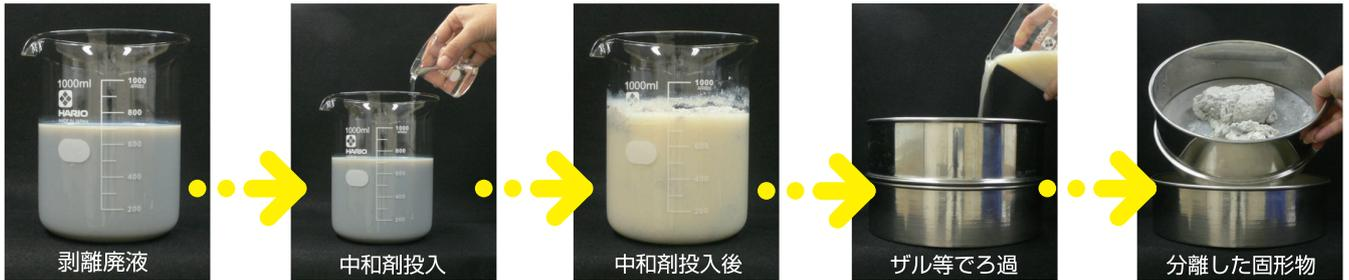
①作業後回収したハクリ廃液に本品を少しずつ加えよく攪拌し、pH測定器またはpH試験紙で確認しながら中和を行ってください。
