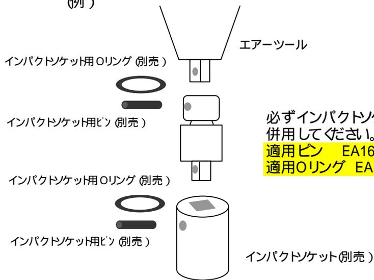
必ずインパクトソケット用ピン、リングを併用してください。
