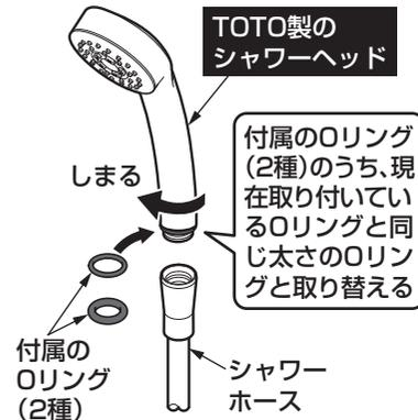
お取り替え後、必ず水を出して確認してください。水が漏れるまたは、Oリングがはみ出ている場合は、もう一方のOリングに取り替えてください。
