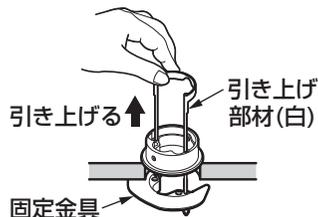
③ 引き上げ部材 (白) を引き上げたまま、ボルト・座金 (2本) を固定金具に通し、手締めで4~5回転ねじ込む。
