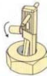
3. クロス棒を使用して、図のようにアイネスを、任意の方向に回します。
