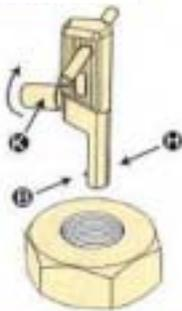
2. ノブKを回し、ブレードBを傷んでいないねじ溝に当て、手の力だけでノブを締めます。
