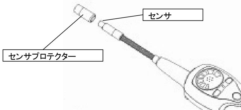
センサはヒーターが断線しない限り、通常1～2年の使用に耐えられますが、感度を保つためにはセンサの表面に水滴、油、チリ、ホコリなどの汚れを付着させないようにすることが重要です。なお、良いコンディションで使用していただくために、センサの定期的な交換(目安として、比較的良好的な使用環境で約1年)をおすすめいたします。
