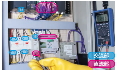
直流、交流電圧が混在する 測定場所で測定を自動で切替
