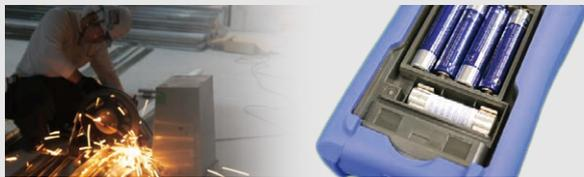
DT4255 では鉄粉等の粉塵が入った場合でも内部短絡を起こさないよう、電圧入力端子に保護ヒューズを内蔵しています。また、自分でヒューズの交換もできます。
