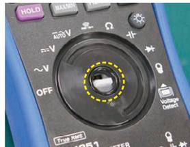
計測器内部に粉塵が侵入すると故障の原因になります。特にロータリースwitchの隙間から入り込み易い為、DTシリーズではロータリースwitch取付部にOリングと呼ばれる、防塵部品を組み込み耐防じん性能を向上させています。
