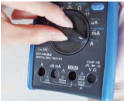
端子シャッター機能で誤挿入を防止 *1 AレンジはDT4282のみ ファンクションと端子接続の誤設定を予防します。 電流測定的位置にロータリスイッチを回すと、電流測定端子挿入口のみ開きます。
