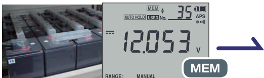
MEM キーを押すだけでデータを内部保存 UPS メンテナンスの効率も UP、バッテリーのセル電圧の測定値をその場で保存できます。最大 400 データの保存が可能です。
