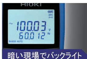
暗い現場でバックライト 暗い現場でも白色バックライトで測定値が読み取れます。
