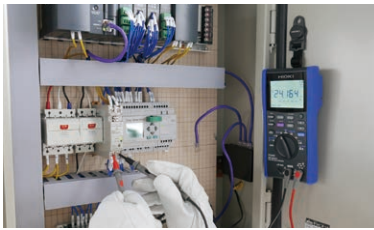
手が塞がらず、両手が自由に作業がはかどるマグネットストラップ マグネットストラップ (オプション) を使用
