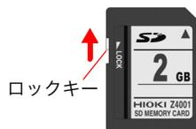
**4** SDメモ리카ードの表面を上にして、▲矢印を挿入口に向けて奥まで差し込む。
