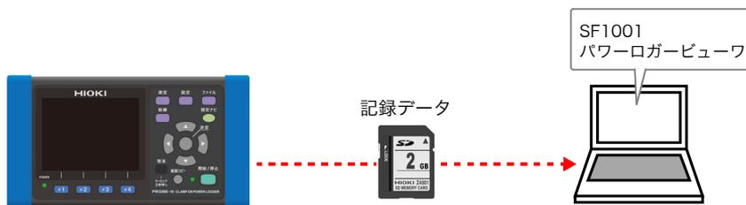
データは、保存した SD メモリカードを SD メモリカードリーダー付きのコンピュータから読み込むか、USB ケーブルを使用して、SD メモリカード内または内部メモリ内のデータをコンピュータへコピーします。
