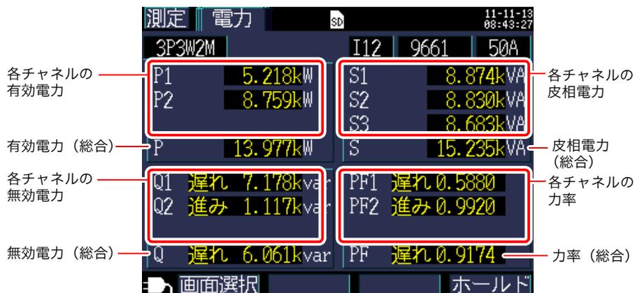
三相 3 線 2 電力計法 (3P3W2M) では、各チャンネルの有効電力、無効電力、皮相電力、力率は 2 電力計法の演算過程の値で物理的意味を持ちません。ただし、各チャンネルの値は結線確認時の参考データになります。
