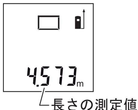
4. 続けて、レーザー光を幅の目標面に当てます。
