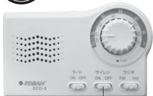
サイレンスイッチ
