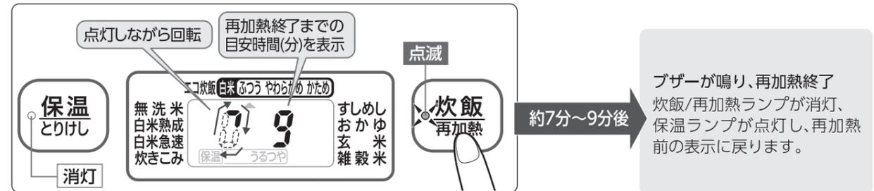
ブザーが鳴り、再加熱終了。炊飯/再加熱ランプが消灯、保温ランプが点灯し、再加熱前の表示に戻ります。
