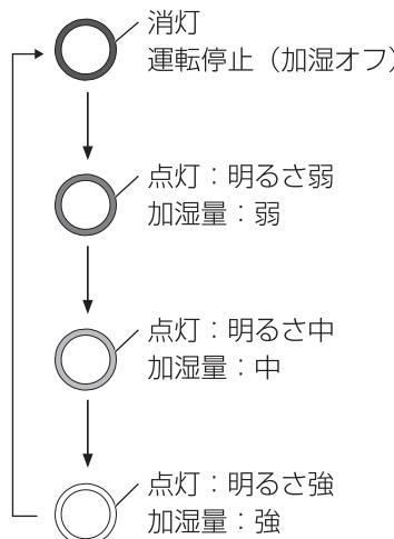
※加湿量選択後、約40秒後にリングライトが消灯します。消灯後に加湿量の切り替えをするときは、電源/操作ボタンを2回押して、切り替えをしてください。(1回押して消灯から復帰し、2回押して加湿量の切り替えができるようになります。)
