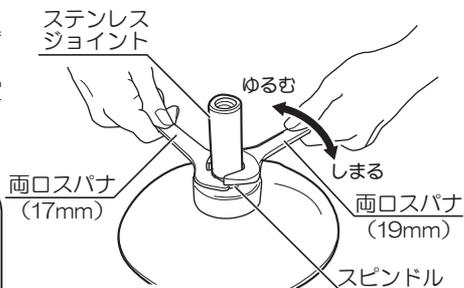
2. ステンレスシャフトをステンレスジョイントにねじ込み、付属品のスパナで締付けます。
