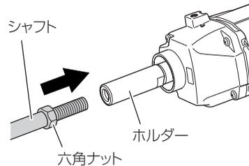
次に、ホルダーの切欠部をスパナ (幅 17 mm) で押さえながら、別の両口スパナ (幅 19 mm 側) で六角ナットを矢印の方向に締付けてください。
