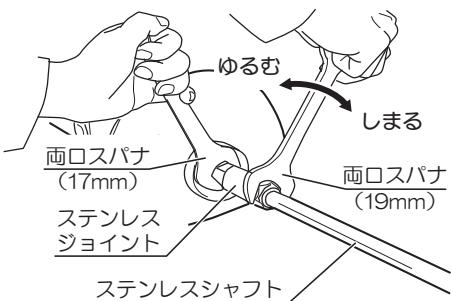
3. リング付ステンレスダブルスクリューの "UP" 刻印の無い方向（リング側）からスクリュー取付ネジをねじ込み、付属の両口スパナの13mm側で強く締付けた後、リング付ステンレスダブルスクリューをステンレスシャフト先端のネジ穴にねじ込みます。
