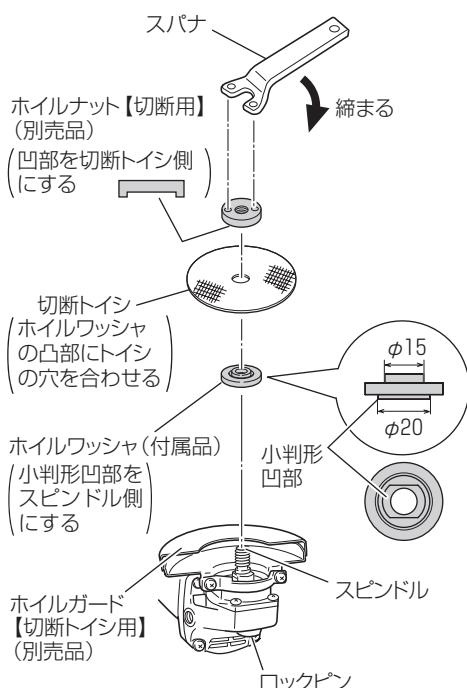
**注** •モーター故障の原因になるので、1回の切込み量は5mm以下にしてください。
