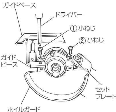
**2** ガイドピースをホイルガードとセットプレートの間にはさみ込み、①小ねじを十分締付けます。
