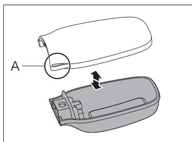
集塵ダストケースは、黒い部分を持ちながらAの部分を持ち上げることで分解ができます。分解した後、中の粉塵を取り出してください。10分おきに中の粉塵を取り出すことをお勧めします。
