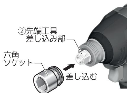
※ 六角ソケットは、先端工具差し込み部②に取り付けた後、若干の遊びがあります。
