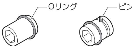
2. 六角ソケットを先端工具差し込み部②に差し込みます。
