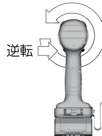
☞ 「正転・逆転・安全ロック切り替えスイッチ④」を中間の位置で固定すると、安全ロックが働き、不用意に「メインスイッチ⑤」を作動させるのを防ぎます。
