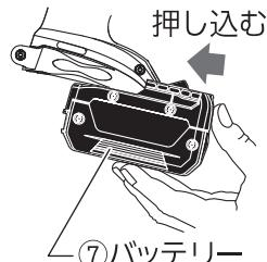
**⚠ 注意** ◆ 不意の脱落を防ぐため、確実に固定されているか確認してください。
