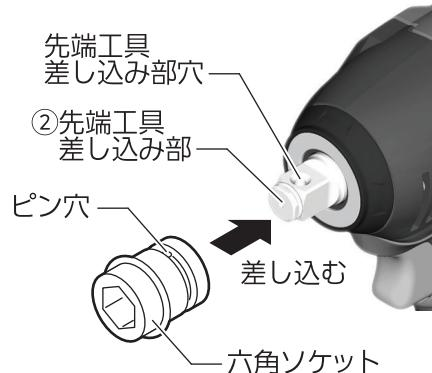
4. Oリングを六角ソケットの溝に戻して、ピンを固定します。
