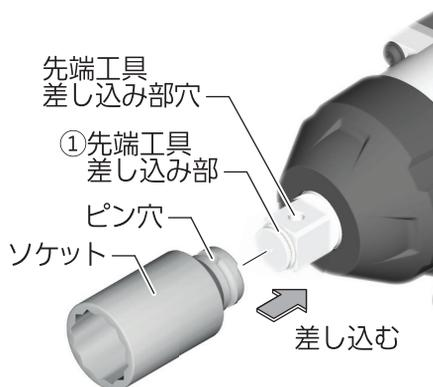
4. Oリングをソケットの溝に戻して、ピンを固定します。
