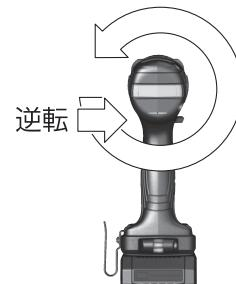
〔※〕 「正転・逆転・安全ロック切り替えスイッチ②」を中間の位置で固定すると、安全ロックが働き、不用意に「メインスイッチ⑧」を作動させるのを防ぎます。
