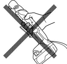
本製品は、スイッチが入っている状態で蓄電池をさし込んでも起動しない構造(再起動防止機能)となっていますが、事故防止のためスイッチが切れていることを確認してください。
