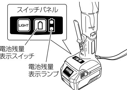
**注** 電池の消耗を少なくするため、残量表示スイッチを押している間のみ、ランプが点灯します。
