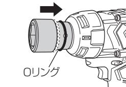
注 •Oリングをソケットの溝からずらすとき、ピンを落としてなくさないようにしてください。
