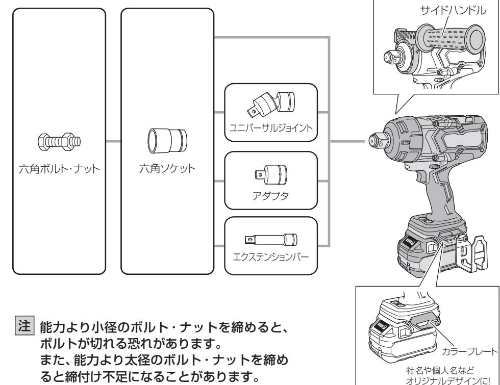
**注** 能力より小径のボルト・ナットを締めると、
