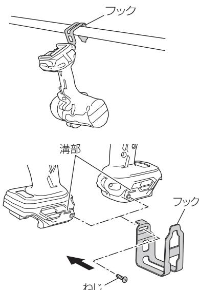
プラスドライバーを使用して、ねじで取付けます。
