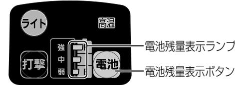
電池残量表示ボタン「電池」を押している間、電池残量を3段階で表示します。電池残量表示ボタンから指をはなすと、打撃モード表示に切り替ります。
