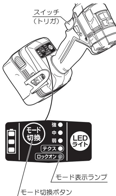
※ ロックオンモードの作業時でも負荷によっては打撃することがあります。打撃を生じる負荷で連続運転すると、モーター焼けするおそれがありますので、そのような負荷での使用は控えてください。
