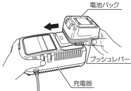
3. 充電が完了したら電池パックを充電器から取り出します。(両側のプッシュレバーを押しながら抜いてください。)
