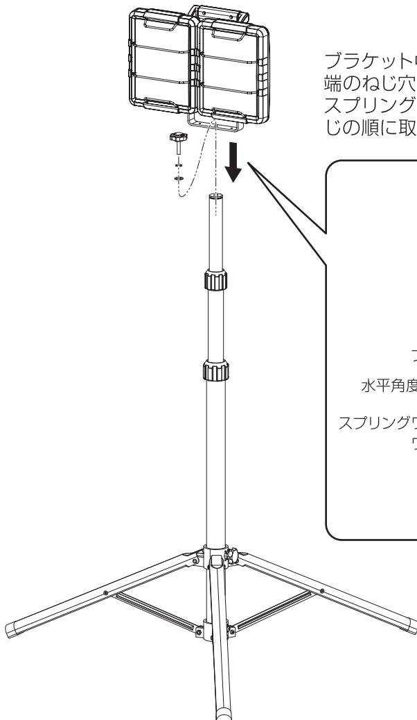
ブラケット中央の穴をスタンドポール先端のねじ穴に合わせて置き、ワッシャー、スプリングワッシャー、水平角度調整ねじの順に取り付け固定してください。
