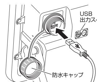
灯体背面左側の防水キャップを外し、USB出力スイッチを押してから、USBポートにUSB端子を挿し込んでください。
