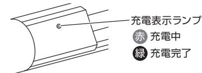
充電表示ランプはAC電源接続時にはスイッチのON/OFFに関係なく点灯します。内蔵バッテリーでの点灯時には表示ランプは点灯しません。
