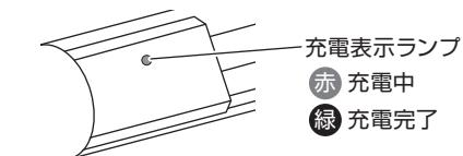
充電表示ランプはAC電源接続時にはスイッチのON/OFFに関係なく点灯します。内蔵バッテリーでの点灯時には表示ランプは点灯しません。
