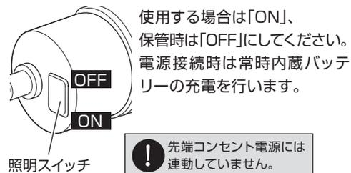
使用する場合は「ON」、保管時は「OFF」にしてください。電源接続時は常時内蔵バッテリーの充電を行います。
