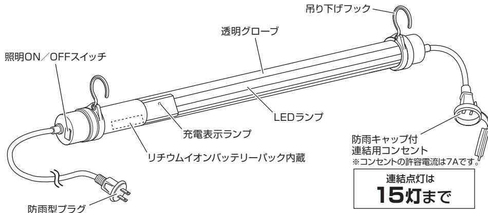
※バッテリーパックの交換はフルの充電・放電にて約500回程度の使用が目安です。
