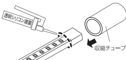
**4** ヒートガンなどを使用し収縮チューブを密着させた後、収縮チューブの上から結束バンドで締付けて24時間以上乾燥してください。
