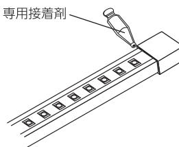
**3** エンドキャップのチに透明シリコン適量を塗布し、エンドキャップを覆うように収縮チューブをかぶせてください。
