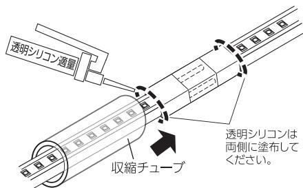
**6** ヒートガンなどを使用し収縮チューブを密着させた後、両側を結束バンドで締付けて24時間以上乾燥してください。
