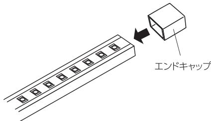
**2** エンドキャップの内側に付属の専用接着剤を隙間なく流し込むように塗布してください。
