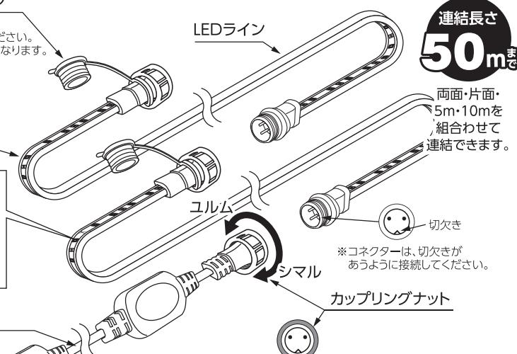
※直角曲げなど、最小曲げ半径以下に曲げないでください。
