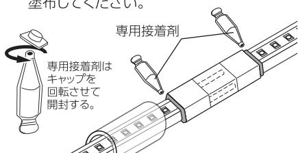
**5** 連結ジョイント両端に透明シリコン適量を塗布し、収縮チューブで覆います。
