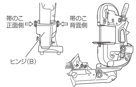
**7** 背面側の D6 ノブボルトの締付け
