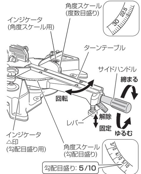
ターンテーブルの角度スケールには、度数目盛りと勾配目盛りを表示しています。勾配目盛りは、水平距離1尺(10寸)に対する立ち上がりを寸で表しています。例えば、勾配目盛り5/10は5寸勾配を表しています。
