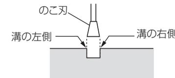
墨線をのこ刃のどちらに合わせて作業するかでレーザーラインの合わせる位置が変わる
