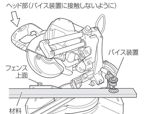
**2** スクリューホルダの位置を調整し、スクリューホルダ後方の6mm ちょうボルトを締め、スクリューホルダを固定します。
