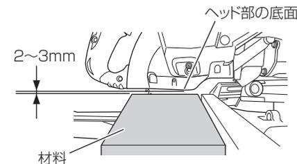
**注** 通常高さの材料切断時は、簡易調整ボルトを回し、下限調整ボルトより先にヒンジに突き当たらないように調整してください。
