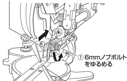
**2** 切断材料を置いたら、材料に軽く当たる所までガードを前に送り、固定します。
