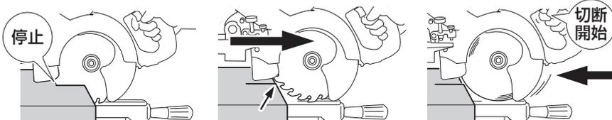
① 切断途中で停止      ② 切断開始位置まで戻す      ③ スイッチを入れる
