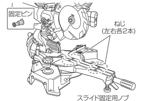
**2** ヘッド部を下げ、固定ピンを押し下げて下限位置に固定しスライド固定用ノブをゆるめます。
