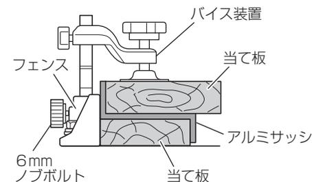
さらに U 形状の材料の場合は、横方向の固定を確実にします。右図で示すように当て板を使用し、材料の切断部の近くまで挟んでバイス装置と市販のクランプを併用して締付けてください。
