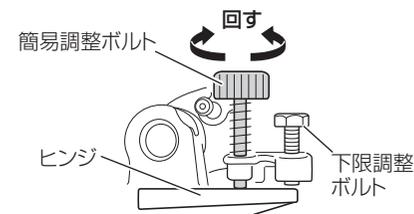
**3** ヘッド部を最大に下げたときに、ヘッド部の底面と材料の上面との間にすき間が、2 ~ 3 mm あくように、簡易調整ボルトを回して調整します。
