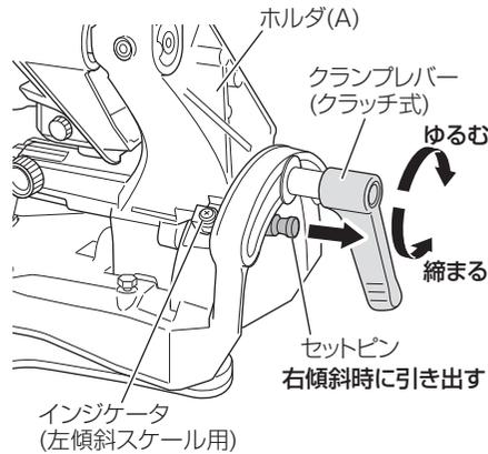
**2** インジケータを希望の傾斜角になるよう傾斜スケールの目盛りに合わせ、クランプレバーを締めてホルダ(A)を固定します。
