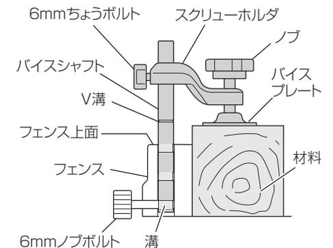
**3** 材料をフェンス面へ確実に押し当て、ノブを回して固定します。
