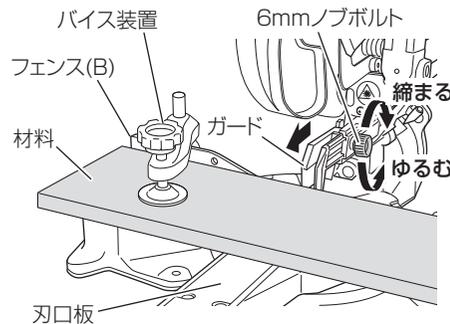
**2** 6 mm ノブボルトをゆるめ、ガードを材料に突き当てて固定します。
