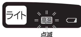
作業を中断し、約30分以上放熱させ、高温お知らせランプが消灯してから使用してください。また、保護機能がくり返し働くような作業は行なわないでください。
