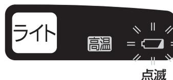
すぐに電池パックを充電してください。リチウムイオン電池は過放電状態になる(カラまで使う)と電池の寿命が大幅に劣化します。過放電防止のため、電池を保護する機能を搭載しております。
