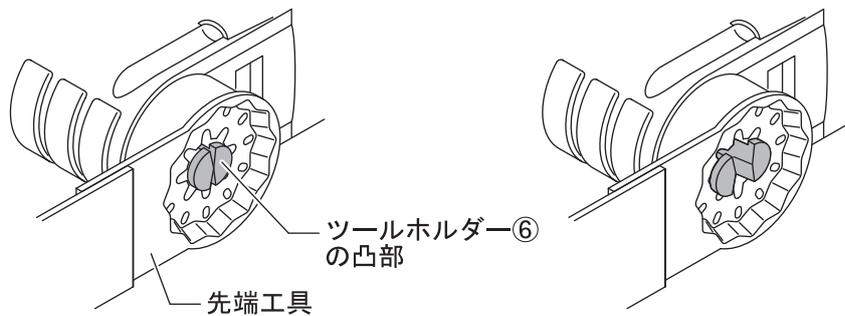
先端工具の向きは、30度ずつ12段階にセットすることができます。
