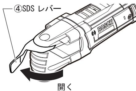
3. 先端工具が外れたら、SDS レバー④から手を離します。
