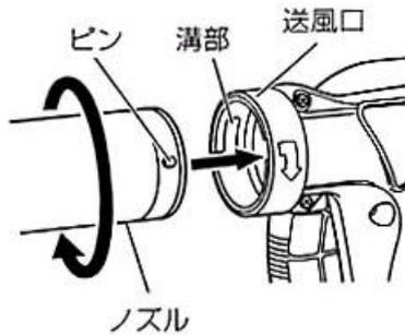
ノズルの外側に出ているピンを、送風口の溝部に合わせてさし込み、ノズルを矢印の方向に十分に回します（左図）
