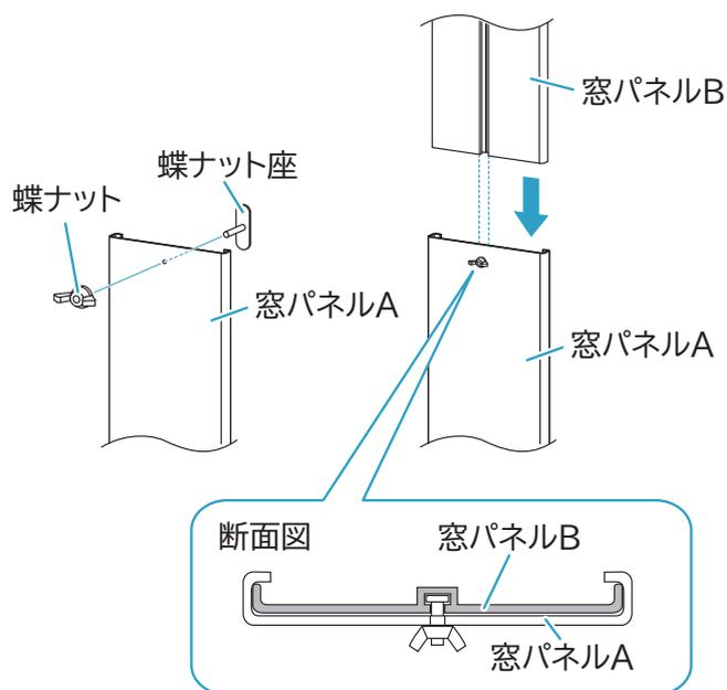
蝶ナットを少しゆるめて、窓パネルを窓枠のレールに合わせて差し込み、蝶ナットを締め付けて固定する
