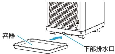
2 下部排水口から下部排水ゴム栓を取り外して排水する
