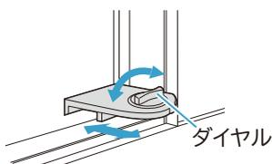
手前と奥の窓や窓パネルとの間に、隙間がなくなるまで窓の戸を端へ押し付け、補助鍵を窓枠に挿入する
