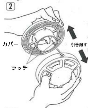
2 カッター下面のラッチ(ロック部、2ヶ所)を指で強く押し込みながら矢印方向に、引き離してください。
