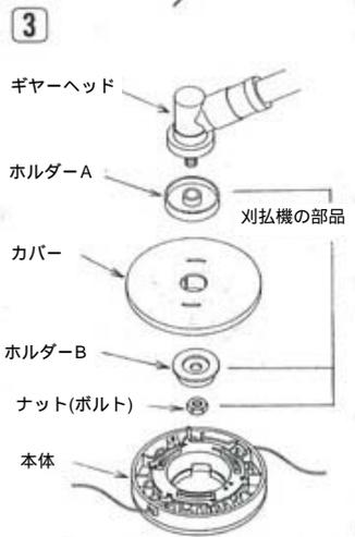
3 外したカバーを、ギヤヘッドに刈刃(鉄刃)と同じ要領でナット(ボルト)でしっかり締め付けてください。(鉄刃用の部品をそのまま使用し偏心取付けにならない様に注意してください。)
