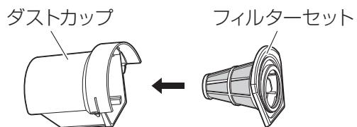
※取り付ける向きに注意してください。正しく取り付けないと、故障の原因になります。
