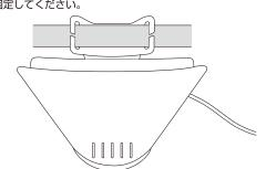
②ファンユニット本体を付けたシリコンバンドをヘルメット後部に取付け、ノズルがヘルメットの内側にきていることを確認し、固定します。
