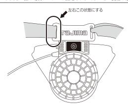
※LEDライトと同時使用の場合は、下図のようにシリコンバンドの中央をバンドアダブターに通して固定してください。
