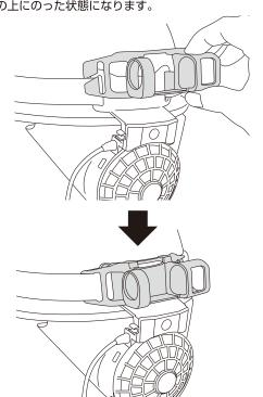
②充電池をバッテリーホルダーに差し込み、コントローラーのバッテリー ケーブル(USB Type-C コネクター)を差し込んでください。最後にバッ テリーキャップを締めて固定します。
