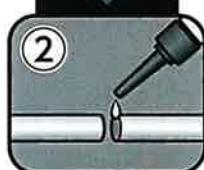
チューブ容器のキャップを外し、キャップ先端の突起をチューブの口に突き刺して開け、付属のノズルキャップを装着して下さい。接合したい部分に接着剤を塗りつけて下さい。
