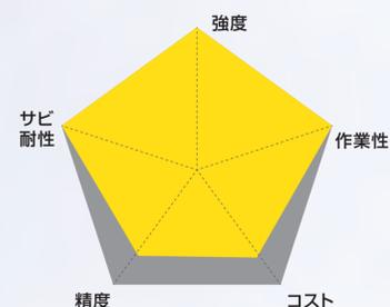
本体には溶融亜鉛めっきを施しており、固定ビスはステンレス製のため、サビに対して強い耐久性を発揮します。雨風にさらされる野外や塩害の懸念、農薬の影響などがある場所での使用、簡単には交換できないため長期メンテナンスフリーにしたい箇所におすすめです。
