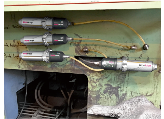
インパルスコネクを取り付ける事で4mまで配管の延長が可能
