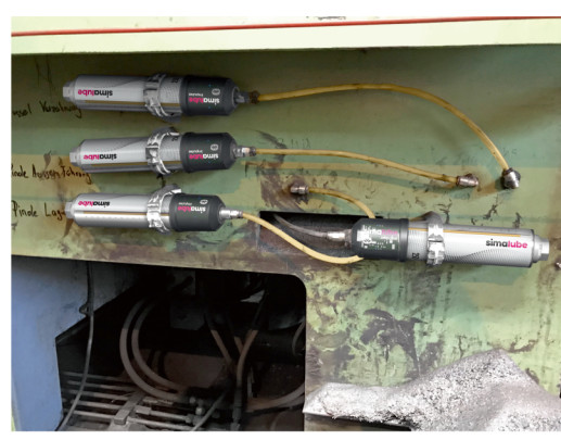
インパルスコネクを取り付ける事で4mまで配管の延長が可能
