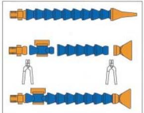
各部品を組み替える事により色々な形状のホースが作れ、 組立て工具を使用する事により容易に着脱が可能です。
